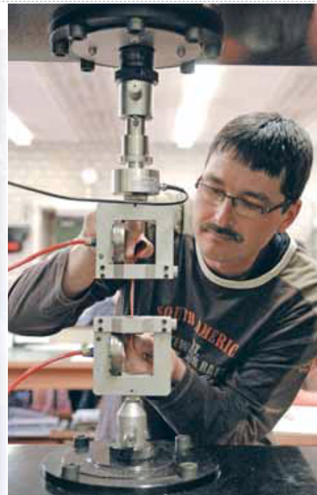
Alles fest? Laborant Holger Deboy testet Polyamid-Garne auf ihre Reißfestigkeit. Bei Airbag-Fasern ist diese Eigenschaft lebensrettend.
