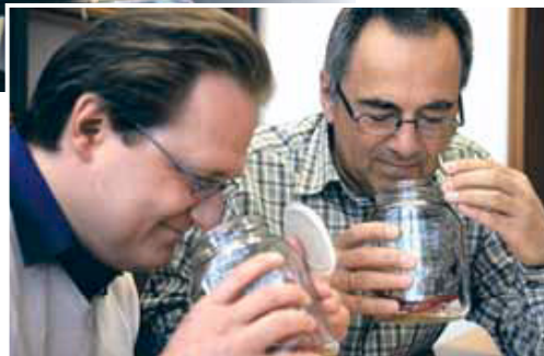
Wonach riecht's? Im Labor beurteilen Alexander Haus (links) und Siegfried Postel den Kunststoffgeruch.
